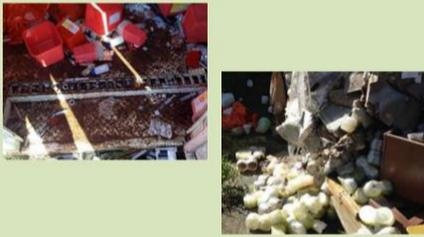
6- Manejo deficiente en la incineración; se aprecian tambores con cenizas y restos de jeringas, lo que comprueba una combustión menor a la temperatura requerida
