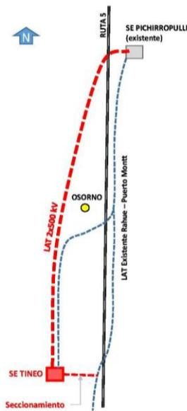
Un 60% del trazado de la nueva línea se desarrolla en paralelo al trazado uno de los circuitos de la línea de alta tensión existente Rahue Puerto Montt, de propiedad de Transelec
